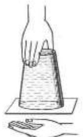
شکل ۲ نمایش اثر فشار هوا
